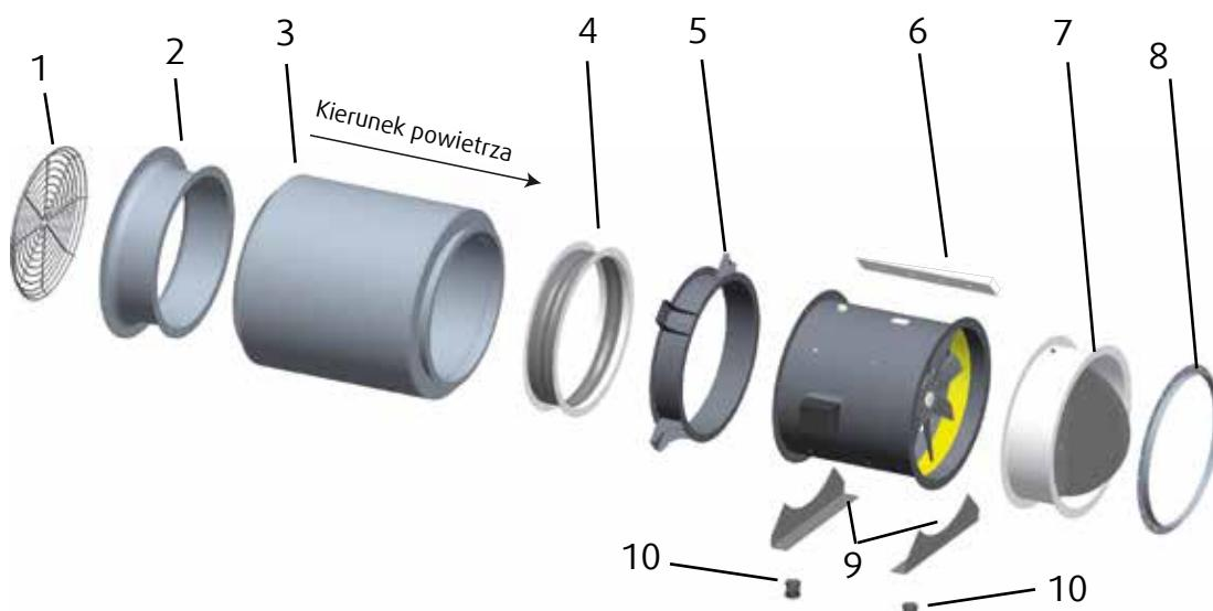
Rys. 3 Typoszereg wentylatorów AXCBF-EX / AXC-EX z wyposażeniem
