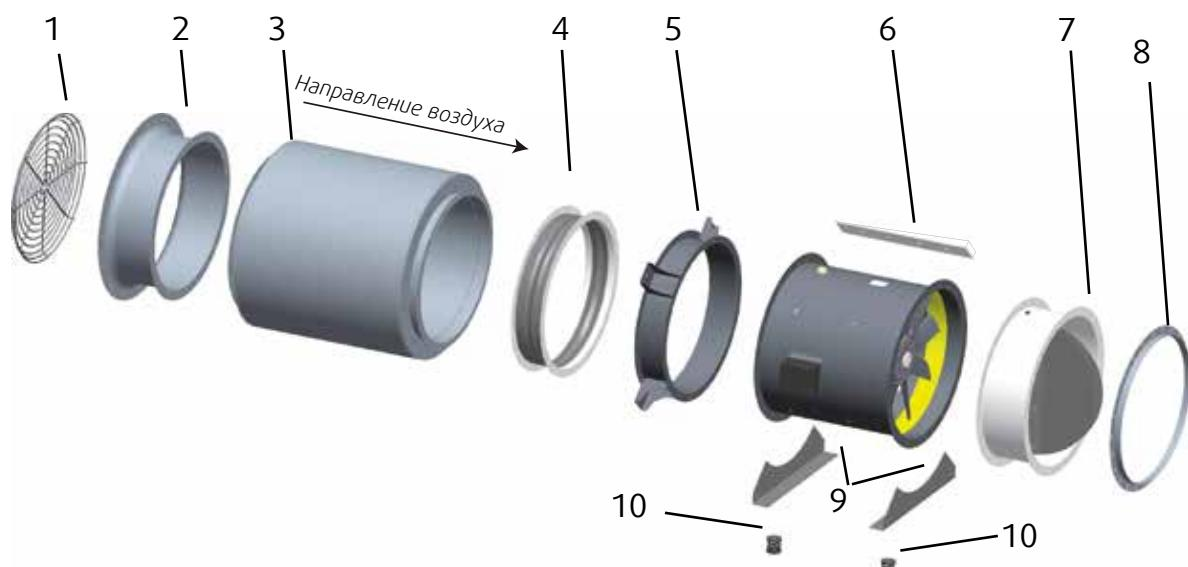
Рис. 3: Вентиляторы серии AXCBF-EX / AXC-EX с принадлежностями
