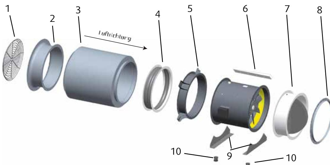
Bild 3: Ventilatoren der Baureihe AXCBF-EX / AXC-EX mit Zubehör
