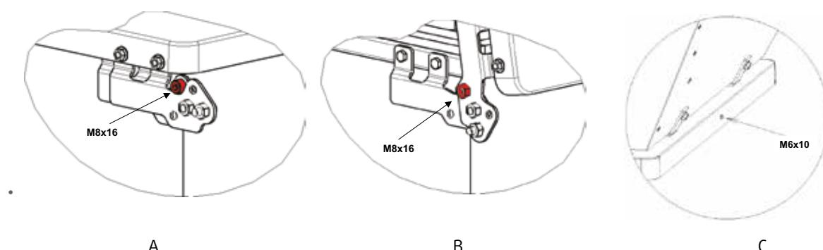
Rys. 9 Zabezpieczenie wentylatora dachowego DVEX
