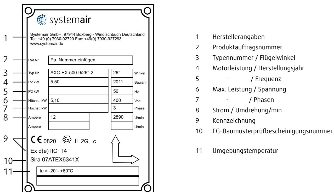
Bild 4: Typenschild der Baureihe AXCBF-EX / AXC-EX
