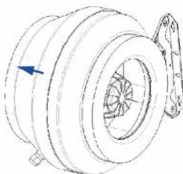
Рис. 30 Направление прямого потока воздуха в вентиляторе RVK-EX
