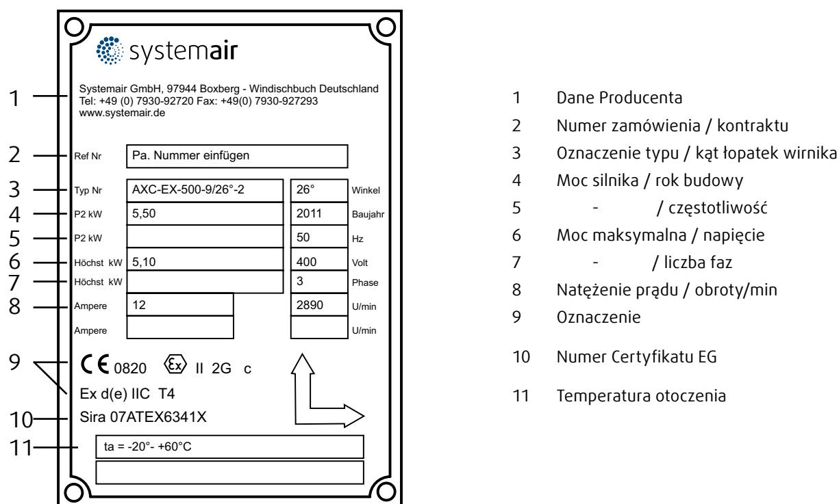
Rys. 4 Tabliczka znamionowa typoszeregu AXCBF-EX / AXC-EX
