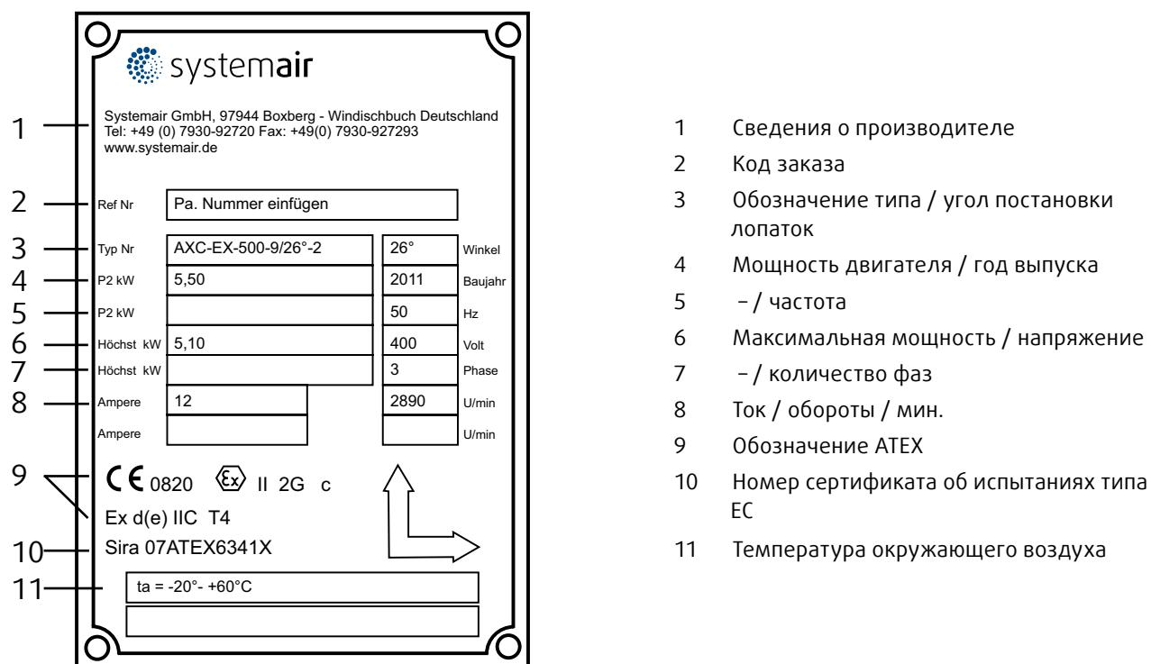
Рис. 4: Заводская табличка вентилятора серии AXCBF-EX/ AXC-EX
