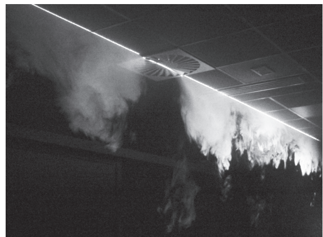
Fig. 1: Isothermal air flow visualisation
