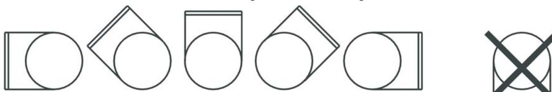
4. Les ouvertures doivent être équipées de grilles solidement fixées ou de bouches d'air d'admission pour empêcher tout contact avec l'élément de chauffe.
